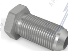
F652678 ADAPTADOR 3/4" UNF JIC 37° x M12
